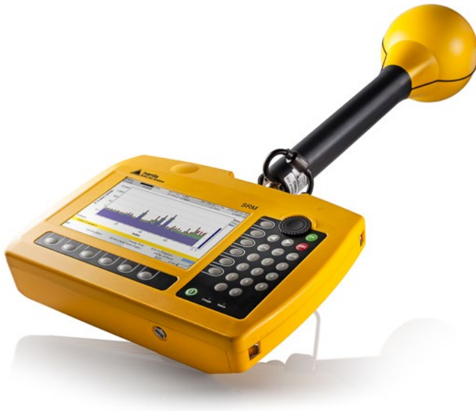
Şekil 2. SRM 3006 EM Alan Şiddeti Ölçüm Cihazı
